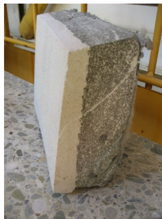
Bild 2: Weißer Spritzmörtel auf Tunnelinnenschale (oben Übersicht, unten Detail)
